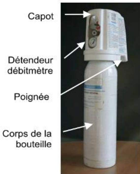
Les bouteilles d'oxygène peuvent être de différents volumes : 2, 5 et 15 litres (volume en eau) contenant respectivement, pleines et sous pression, (200 bars) 0,5, 1 et 3 m<sup>3</sup> d'oxygène (fig. 5.11).
